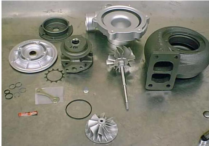
O turboalimentador é composto por um compressor de ar centrífugo, directamente ligado a uma turbina centrípeta.
