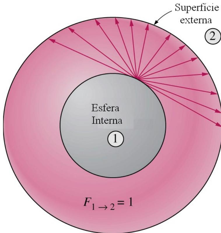
Em uma geometria que consiste de duas esferas concêntricas, o Factor de Forma  $F_{1 \rightarrow 2} = 1$ , porque a radiação toda que deixa a superfície da esfera menor será interceptada pela esfera maior.
