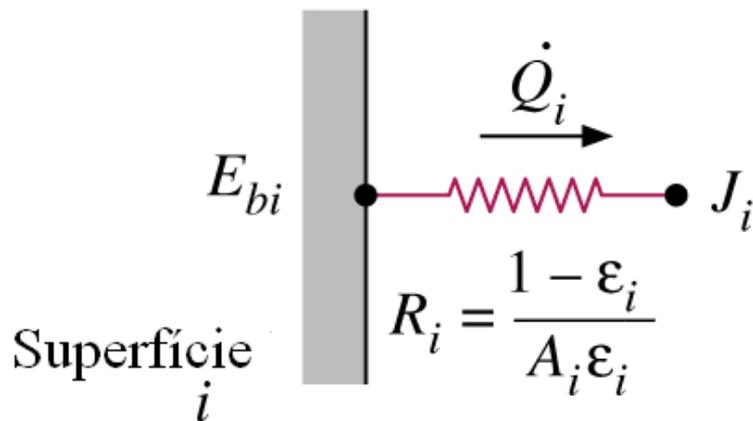
Analogia eléctrica da resistência de uma superfície à radiação
