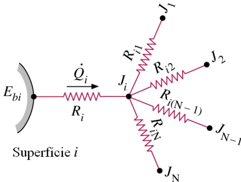
Representação de uma rede de transferência de calor líquida da superfície  $i$  para as restantes  $N$  superfícies do compartimento
