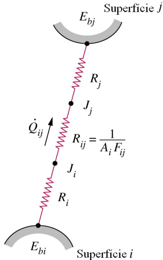
Analogia eléctrica a resistência do espaço à radiação
