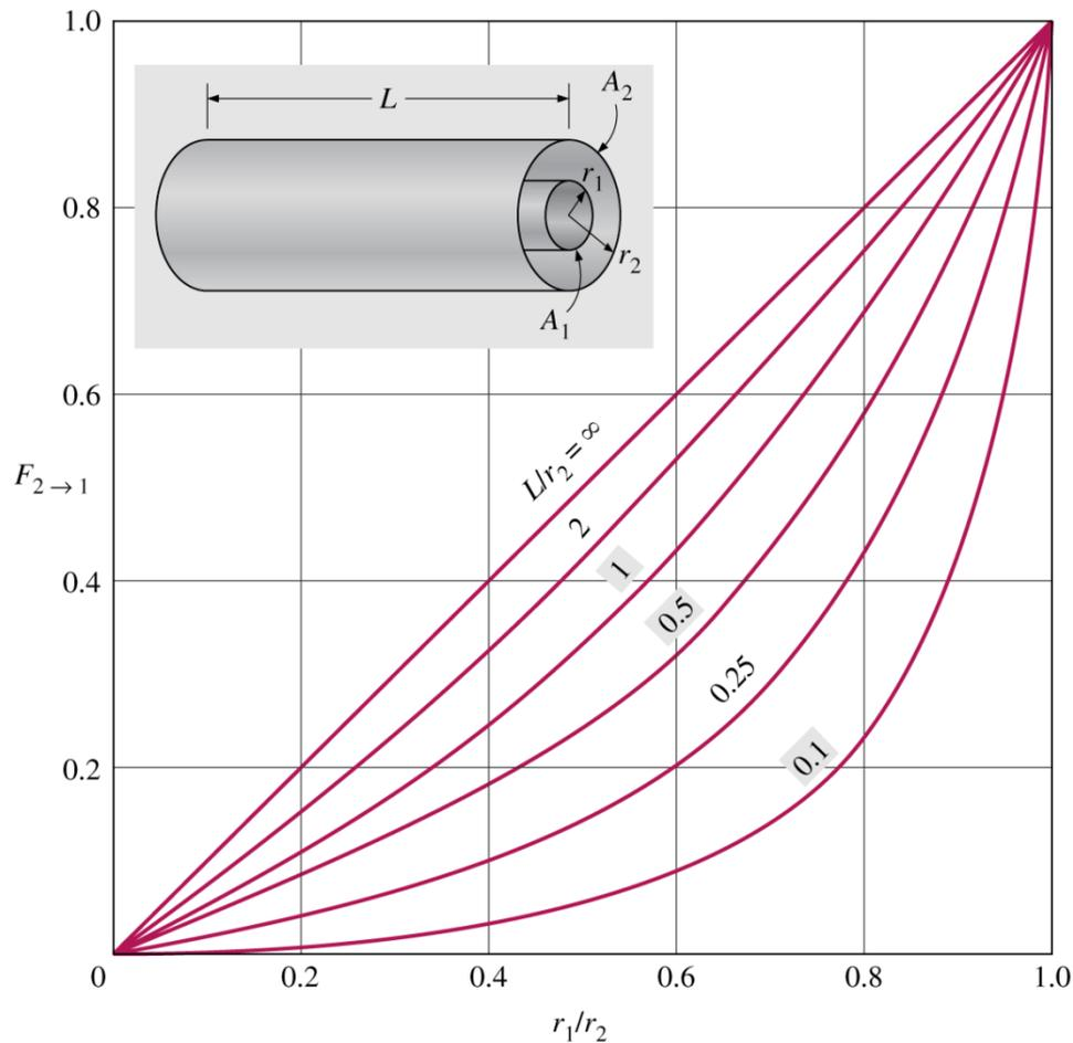
Factor de Forma para dois cilindros concêntricos de comprimento finito: (a) do cilindro exterior para o interno, (b) do cilindro externo para si próprio
