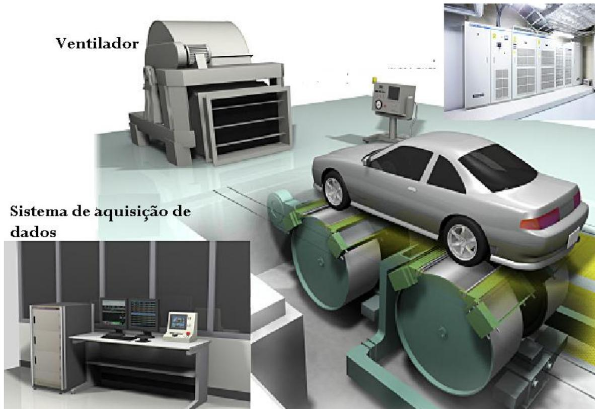
Um dinamómetro de chassi é um equipamento de teste equipado com rolos para as rodas de um veículo, capaz de fornecer como entrada a tracção e saída a medição da potência e torque nas rodas.
