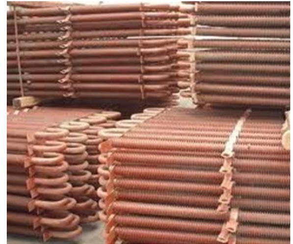
Figura 11.28 Aquecedor de ar de Serpentina
