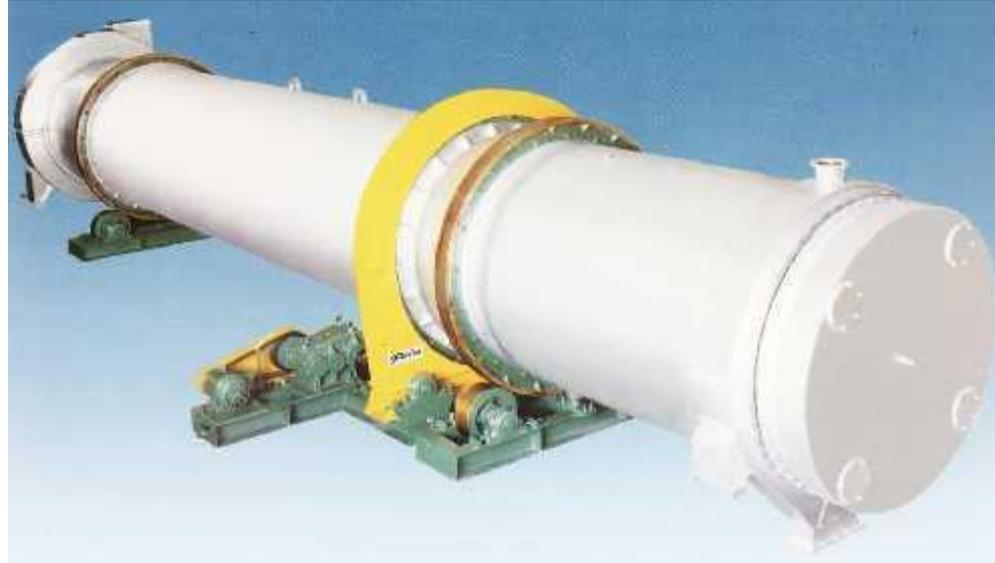
É utilizado em aplicações onde o material não pode ter contacto com os gases de combustão e quando o material seca ou calcina a uma baixa temperatura. Conhecido também como forno de duplo cilindro.
