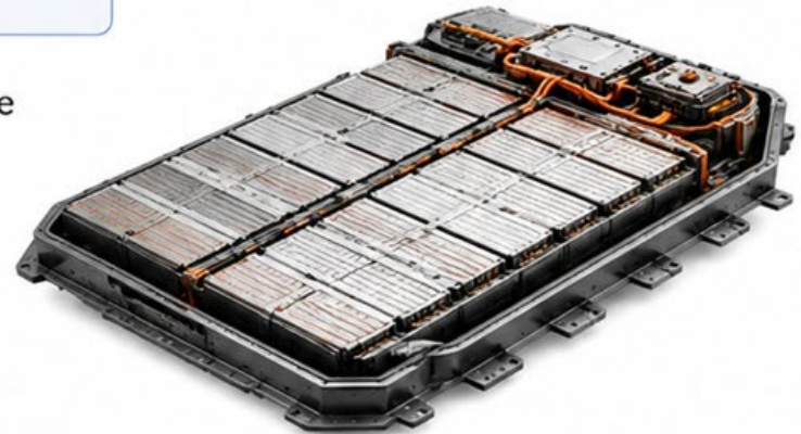
Exemplo de conjunto de baterias (pack) instalado sob o piso do veículo.
