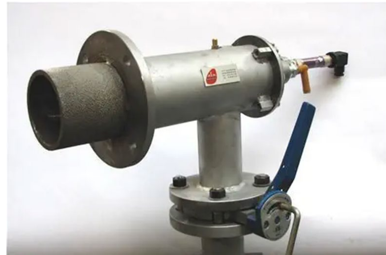
Figura 16.4 Queimador com pré-mistura
