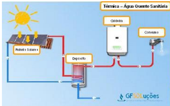
Figura 21.2 – Água quente sanitária
